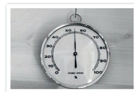
Obr. 7 – Vlasový vlhkoměr, měření vlhkosti vzduchu
