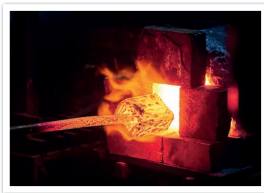
Obr. 1 – Zahřívání železa v kovářské výhni, tepelná výměna
