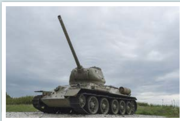
Obr. 7 – Tank, pásy zmenšují tlak na plochu
