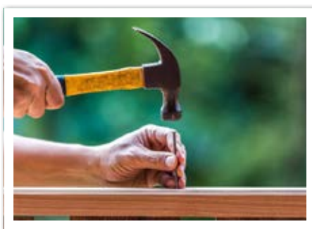
Obr. 2 – Zatloukání hřebíku, kladivo působí silou na hřebík a hřebík zase na kladivo
