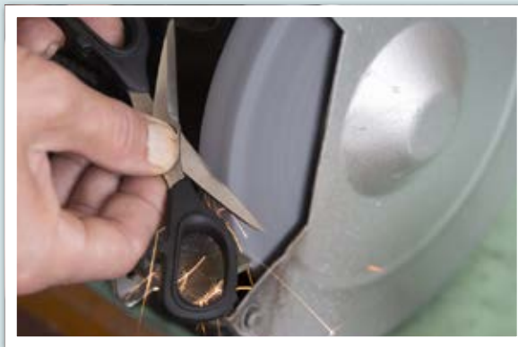
Obr. 5 – Broušení nůžek, příklad využití zvětšení tlaku na plochu
