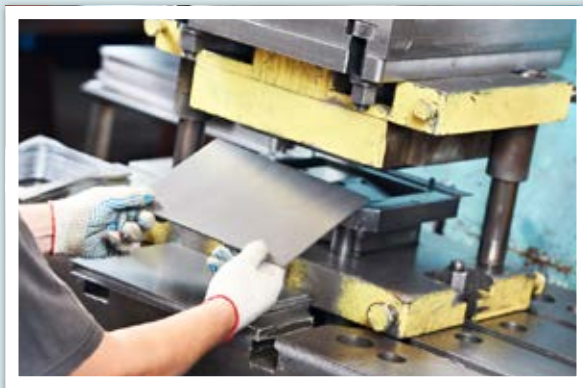
Obr. 4 – Lis, příklad využití zvětšení tlaku na plochu
